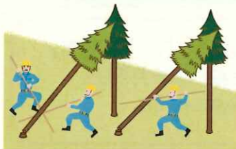
(図2) かかり木の処理
