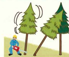
(図4) かかり木に激突させるためにかかり木以外の立木の伐倒
